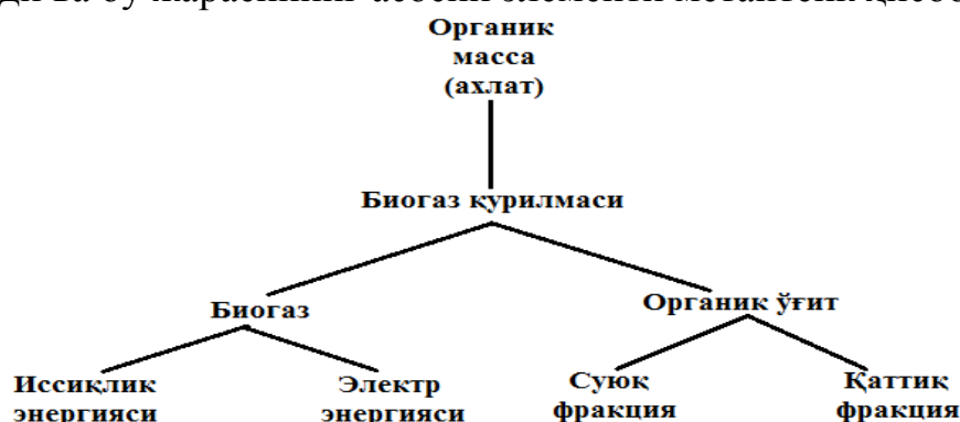
1-расм. Қишлоқ хўжалиги ишлаб чиқариш чиқиндиларидан биогаз ва органик ўғит олишнинг намунавий тизмаси.
